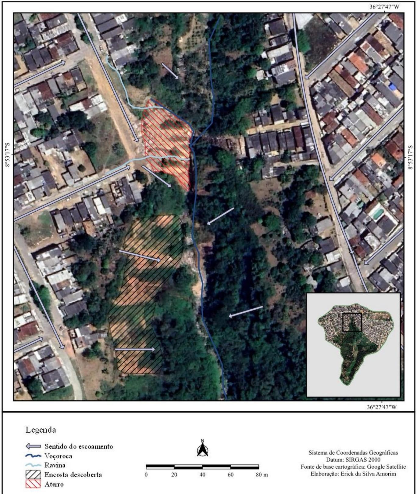
Percebe-se que o setor da encosta à esquerda do vale encontra-se com áreas de solo descoberto, com convergência dos fluxos de escoamento superficial.
