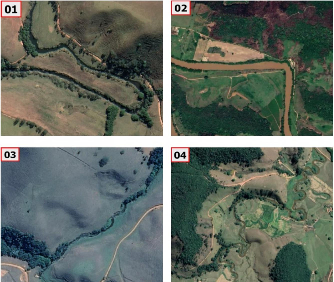
Anomalias destacadas: 01- Trecho meandrante comprimido; 02- Mudança brusca de direção; 03- Trecho encaixado; 04 - Trecho de padrão muito meandrante.
